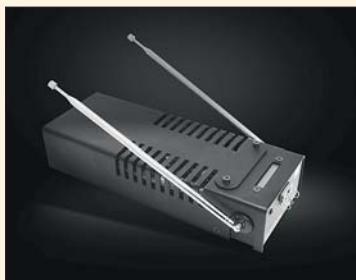
Генератор шума по цепям электропитания, заземления и ПЭМИ ЛГШ-503
