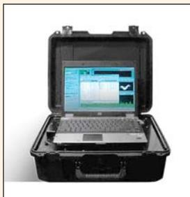
Автоматизированная станция радиоконтроля (АСРК)
