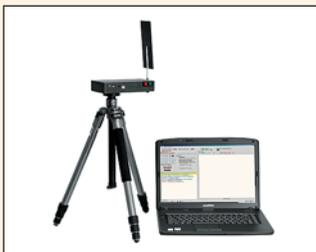
Комплекс определения коэффициента реального затухания электромагнитного поля
