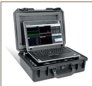
Автоматизированный комплекс выявления и идентификации электронных устройств беспроводной связи
