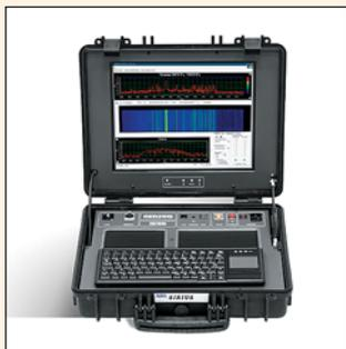
Программно-аппаратный комплекс для анализа сигналов в проводных линиях активным методом
