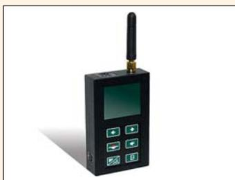
Тестер блокираторов сотовой связи и беспроводной передачи данных
