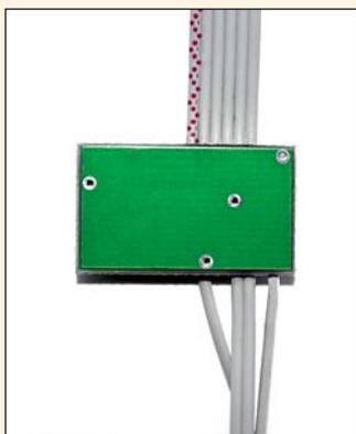
Устройство блокирования несанкционированного включения микрофонов цифрового телефонного аппарата
