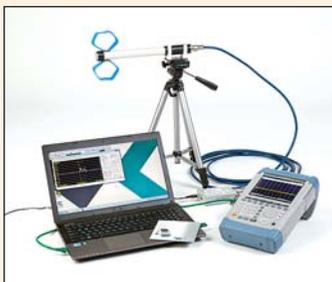
Автоматизированная система оценки защищенности технических средств от утечки информации по каналу ПЭМИН
