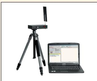
Вспомогательное оборудование для определения величины реального затухания электромагнитного поля
