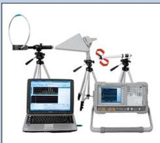
Программно-аппаратный комплекс поиска и измерения ПЭМИН
