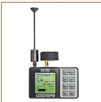
Анализатор электромагнитного поля
