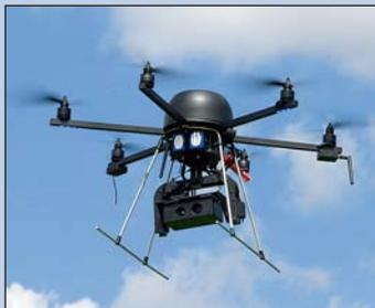
Комплекс воздушного радиотехнического контроля на базе ДПЛА
