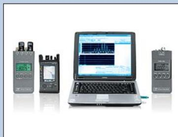
ПАК для измерения параметров волоконно-оптических систем
