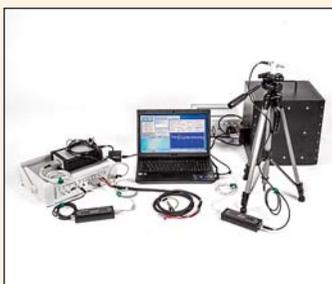
Автоматизированная система исследования эффекта акустоэлектрических преобразований в речевом диапазоне частот
